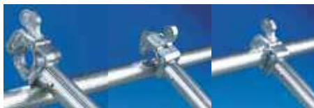
Dispositivo di ancoraggio rapido: Ogni traversa viene montata con un unico movimento consentendo un grande risparmio nei tempi di montaggio / smontaggio (ca. 30%)
