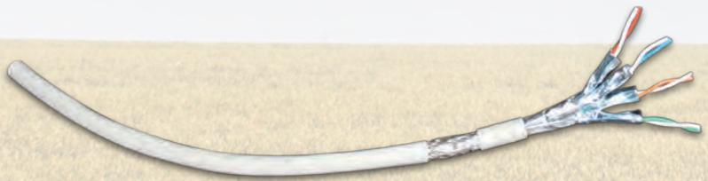
Cavi dati per telecomunicazioni schermati S/FTP cat.7A 4 coppie twistate 100 Ohm con conduttori in rame rosso sezione 23 AWG completi di isolamento poliolefinico adatti alla realizzazione del cablaggio strutturato per la trasmissione analogica e digitale di segnali voce e dati in classe F. Proposti con guaina LSZH (bassa emissione di fumi senza alogeni). Certificazione CPR – regolamento Europeo (UE/305/2011) – Classe B2ca, s1a, d1, a1.
