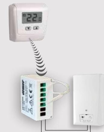
Esempio di collegamento con un attuatore remoto a 1 canale. L'attuatore remoto deve essere alimentato solo da rete elettrica.
