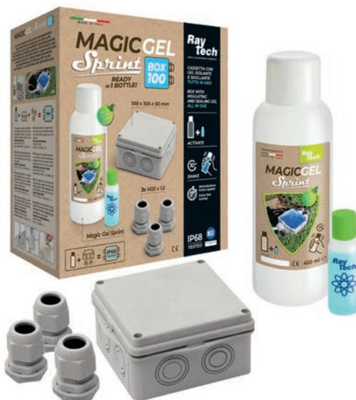
Il kit comprende una confezione di Magic Gel Sprint 450, gel formulato per una polimerizzazione extra-rapida direttamente all'interno del flacone, ed una cassetta 100 x 100 x h50 mm: una volta preparata la connessione nella cassetta, si prepara il gel semplicemente colando nella bottiglia grande il contenuto di quella piccola. Quindi si agita e si versa. Operazione terminata!
