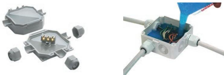
Le cassette pre-riempite in gel semplificano in modo sostanziale l'installazione: infatti, nelle cassette "convenzionali", occorre innanzitutto forare le pareti ed installare i pressacavi; quindi, si pre-infila il cavo per determinare gli sguainamenti, lo si estrae per prepararne le teste. Poi lo si re-infila e lo si connette. Si stringono i dadi ed infine, per ottenere un grado di protezione effettivamente IP68, si cola il gel riempitivo e si attende la sua reticolazione.
