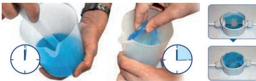
Colare i componenti nel misurino, miscelare e lasciare reticolare (circa 15 minuti). Togliere l'isolante, e posizionarlo in piccole parti attorno alla connessione in modo che ne sia completamente ricoperta. Naturalmente può utilizzarsi l'isolante conservato da precedenti miscele.
