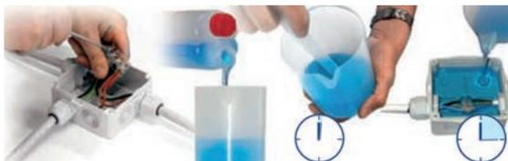
Si può usare l'isolante Magic Power fornito nella bottiglia bi-componente, in proporzione 1:1, semplicemente colandolo, dopo la miscelazione, nella cassetta fornita nel kit, per proteggere e sigillare le connessioni all'interno. Il gel impiega solo 15 min circa a reticolare, ma la cassetta può essere immediatamente alimentata.
