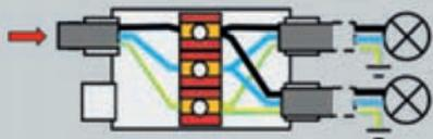
Impianto derivato parallelo con 3 cavi tripolari fino a 3 x 4 mm²
