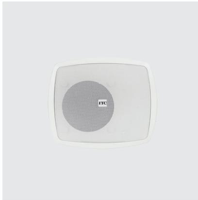
Diffusore a plafoniera di forma rettangolare dai lati leggermente arrotondati, indicato per un'ottima qualità di riproduzione degli annunci vocali e della musica di sottofondo. Corpo in ABS con griglia in metallo verniciato, corredato di ganci rotanti per un semplice e rapido montaggio a controsoffitto. In alternativa può essere installato a parete su scatola da incasso tipo GEWISS PT5 non fornita. Completo di modulo amplificatore con trimmer per una migliore regolazione del livello sonoro.
