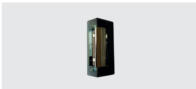
Funzionamento "a lancio di corrente" con auto richiusura, ala di contro scrocco regolabile, completamente simmetrico e reversibile. Alimentazione a 12 Vac/dc, assorbimento 480 mA.
