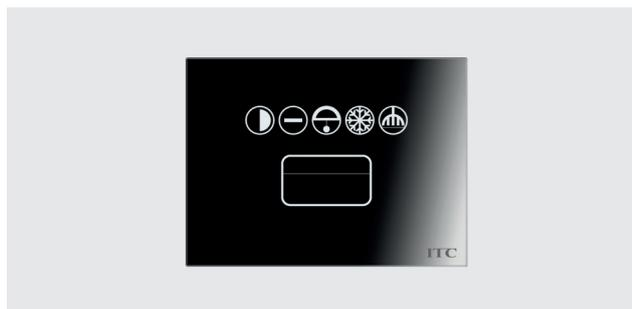
Letto di schede di prossimità di tipo Mifare 13,56MHz, realizzato mediante pannello touch in vetro temperato a variazione capacitiva. Consente l'accesso alla camera in maniera differenziata per cliente, personale di servizio, direttore, manutentore, ecc. è dotato di pulsante "campanello" e di icone per le segnalazioni "cliente in camera", "non disturbare", "frigobar da controllare" e "camera da pulire". Fornisce, inoltre, le segnalazioni "scheda valida", "scheda non valida" e "allarme in corso".
