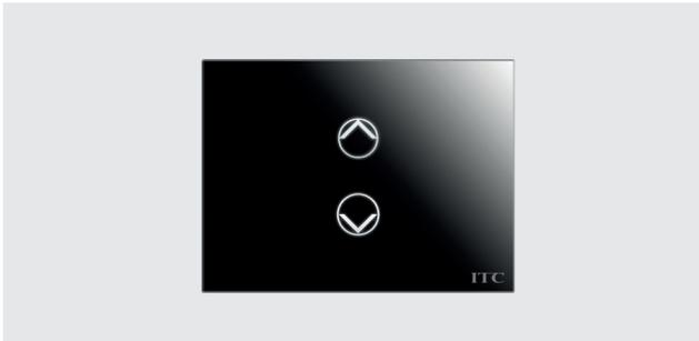
Pannello touch in vetro temperato a variazione capacitiva per comando tapparelle. È dotato di due tasti a sfioramento retroilluminati per apertura e chiusura tapparelle elettriche. Alloggiamento in scatola da incasso 3 posti. Collegamento all'unità UGC-IP o ad ulteriori unità e pannelli mediante connettore RJ12 per trasmissione dati e per alimentazione a 12Vdc. Dimensioni 127x95x9mm (+44mm interni). Peso 0,2 Kg. Colore nero, bianco.
