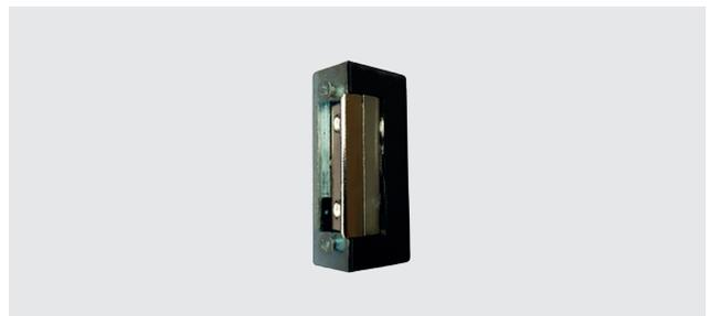
Funzionamento "a lancio di corrente" con auto richiusura, ala di contro scrocco regolabile, completamente simmetrico e reversibile. Alimentazione a 12 Vdc, assorbimento 250 mA, bobina 100% ED "fail secure".
