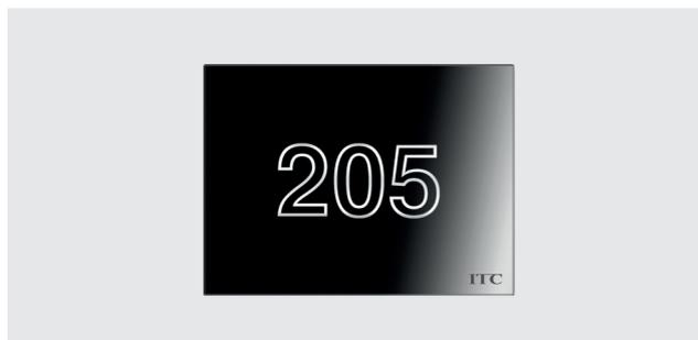
Pannello in vetro temperato retroilluminato per indicare il numero della camera. Stessa linea ed estetica degli altri pannelli in vetro. Alloggiamento in scatola da incasso 3 posti. Collegabile da qualsiasi altro pannello in vetro tramite connettore RJ12 per alimentazione. Possibilità di scegliere 3 diversi livelli di luminosità tramite jumper interno. Dimensioni 127x95x9mm (+44mm interni). Peso 0,2 Kg. Colore nero, bianco.
