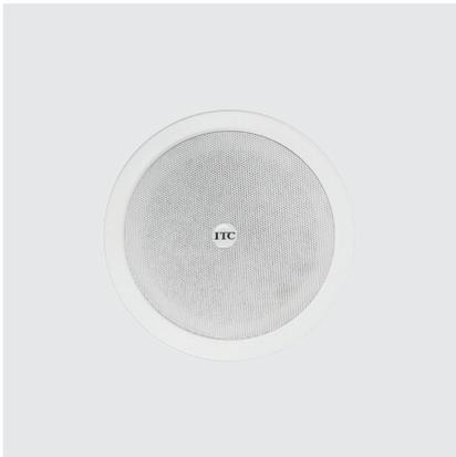
Diffusore a plafoniera di forma circolare, indicato per un'ottima qualità di riproduzione degli annunci vocali e della musica di sottofondo. Corpo e griglia in metallo verniciato, corredato di ganci a molla per un semplice e rapido montaggio a controsoffitto. Completo di modulo amplificatore con trimmer per una migliore regolazione del livello sonoro.
