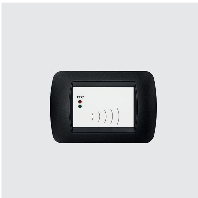
Abilita l'accesso ad ambienti comuni mediante scheda transponder formato ISO 7816, in maniera differenziata per cliente, direttore, personale di servizio, manutentore, ecc. Distanza massima di lettura 5 cm. È dotato di 2 led per indicazione validità tessera e di un contatto pulito per apertura porta, realizzato mediante relè 24V, 4(2)A.
