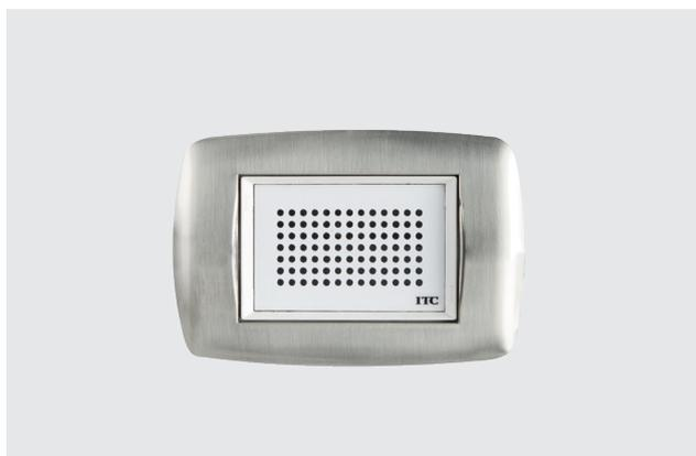
Microfono electret cardioide ad alta sensibilità, indicato per un'ottima qualità di riproduzione della voce, nelle situazioni in cui chi parla si trova a distanza dal microfono stesso. Da abbinare all'alimentatore amplificato A20/5. Capsula microfonica e circuito preamplificatore montati su supporto in vetronite con lexan adesivo, idoneo per l'installazione in scatola da incasso 503 che occupa interamente. Disponibile in molteplici serie civili. Peso: 0,09 Kg.
