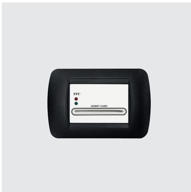
Abilita l'accesso ad ambienti comuni in maniera differenziata per cliente, direttore, personale di servizio, manutentore, etc. È dotato di bocchetta di inserimento illuminata per chip card formato ISO 7816, di 2 led per indicazione validità tessera e di un contatto pulito per apertura porta, realizzato mediante relè 24V, 4(2)A.
