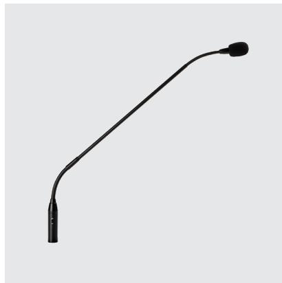
Microfono professionale electret unidirezionale, bilanciato elettronicamente, caratterizzato da una risposta in frequenza precisa ottimizzata per la ripresa della voce. Richiede alimentazione "Phantom" di tipo standard con range da 9 a 52Vdc. Asta a collo di cigno semirigida in metallo, con connettore XLR per innesto rapido su base specifica BMG. Corredato di presa XLR da incasso e supporto per innesto su asta da pavimento APD.
