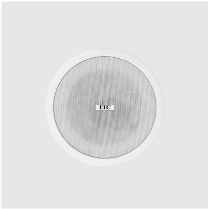
Diffusore a plafoniera di forma circolare, indicato per un'ottima qualità di riproduzione degli annunci vocali e della musica di sottofondo. Corpo e griglia in metallo verniciato, corredato di clips a molla e staffa a ponte per un semplice e rapido montaggio a controsoffitto. Completo di trasformatore di linea con potenze selezionabili per una migliore regolazione del livello sonoro.
