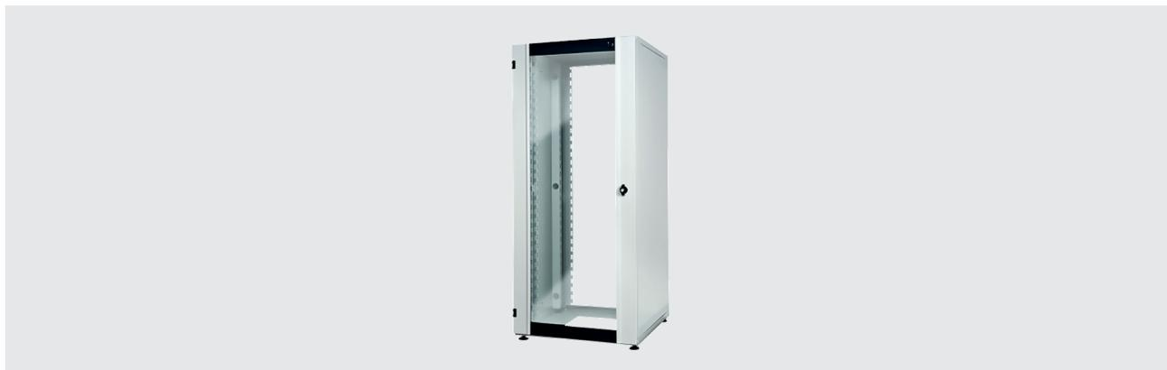
Struttura in lamiera completa di fondo con flangia per passaggio cavi, coperchio e fianchi laterali con feritoie per aerazione. Telaio interno sistema 19" (482,6 mm), caricabile fino 500 kg. Messa a terra su fondo e fianchi. Grado di protezione IP30. Completo di 4 piedini con appoggio in gomma regolabile in altezza. Finitura RAL7035.
