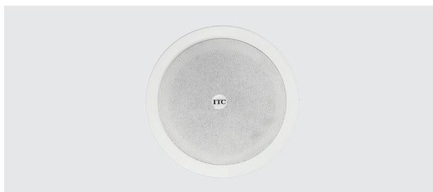
Diffusore a plafoniera di forma circolare, indicato per un'ottima qualità di riproduzione degli annunci vocali e della musica di sottofondo. Corpo e griglia in metallo verniciato, corredato di ganci a molla per un semplice e rapido montaggio a controsoffitto. Completo di trasformatore di linea con potenze selezionabili per una migliore regolazione del livello sonoro.
