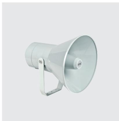
Diffusore da parete 30W, 20W, 10W, indicato per un'ottima qualità di riproduzione della voce negli ambienti in cui è richiesta un'elevata resa acustica. Corpo in ABS con campana rotonda, corredato di staffa a "U" regolabile, per un semplice e rapido montaggio a parete. Completo di trasformatore di linea con potenze selezionabili per una migliore regolazione del livello sonoro.
